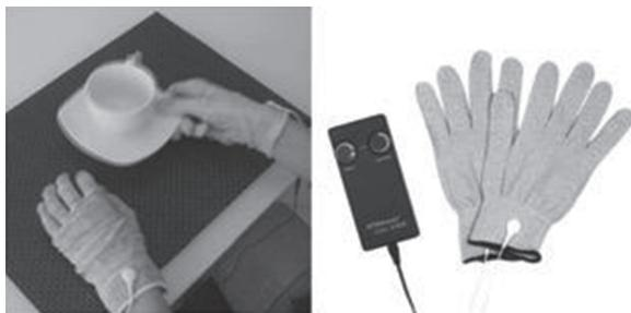
Рис. 4. Прибор для имитации старческого тремора
